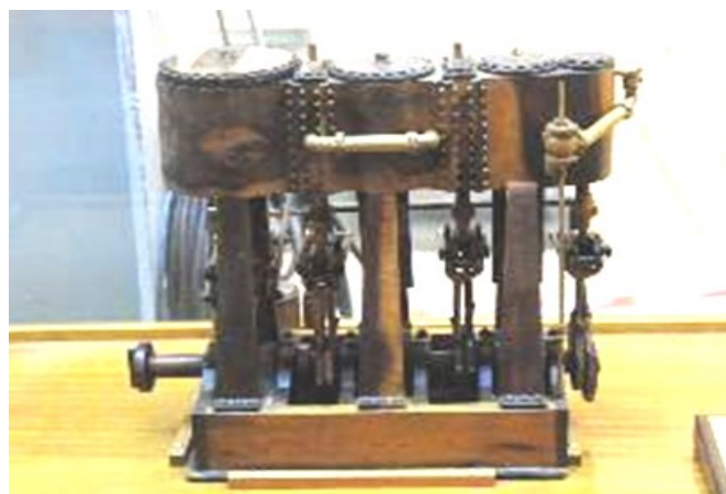
Μικρογραφία παλινδρομικής μηχανής, που φτιάχθηκε όλη από ξύλο, με μοναδικό εργαλείο μια λάμα, στα χρόνια της εξορίας.
